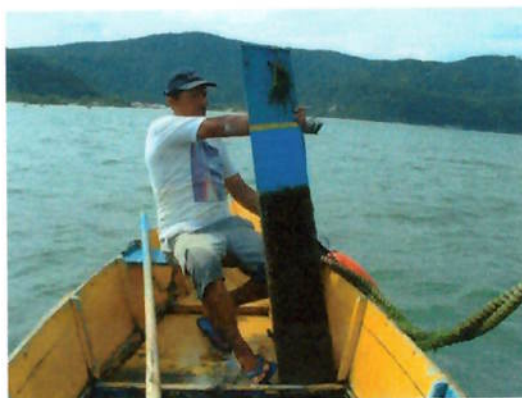
Figura 24: Ensaio com resina de mamona (depois)
